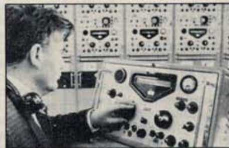
Fig 4. I brittiskt bruk under många år fanns givetvis åtskilliga exemplar av den aktuella Racal-mottagaren – här i användning hos BBC i avlyssningscentralen i Reading. En mottagare dimensionerad för proffsbruk!
