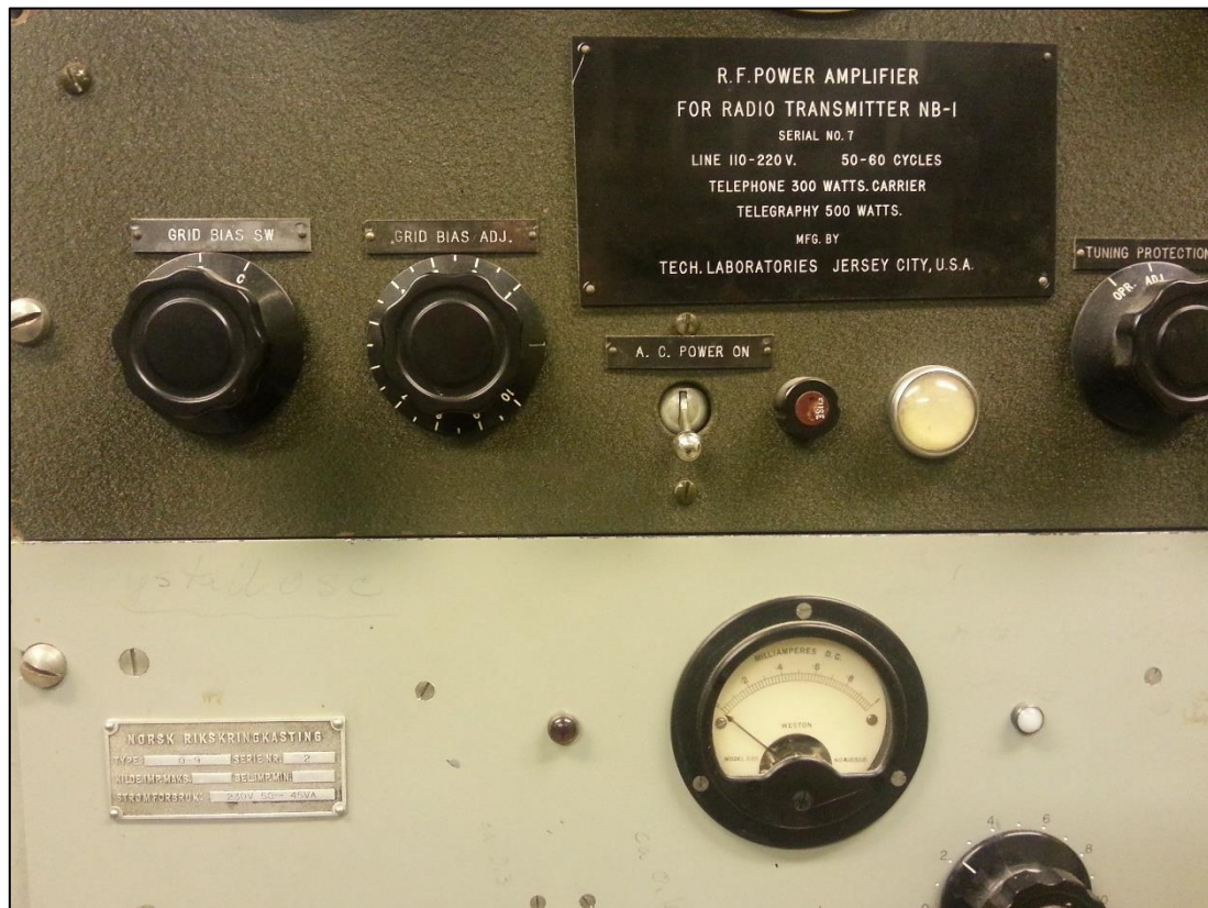
Del av LLT Geilo Kringkaster sin Tech Labs tx. Skilt med RF Power Amplifier Radio transmitter NB-1 og Norsk Rikskringkasting. Bilde tatt av forf. i kjelleren på Bergen Kringkaster 2016.
