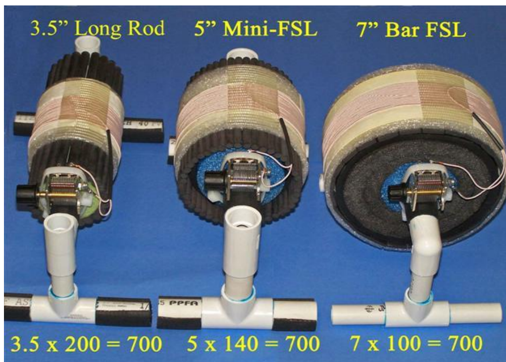
Ferrite Sleeve Loopar i olika fasonger. Samtliga byggda av Gary DeBock.
